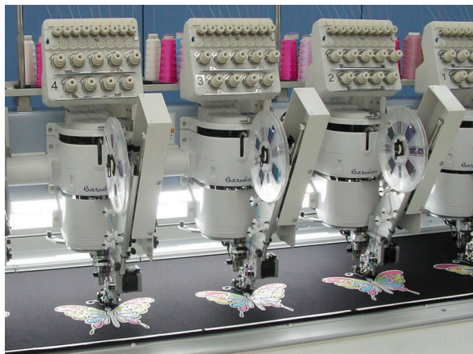
YN heads sewing a multi-colour sequin design
